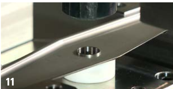
10 Het vervaardigen van een uitsparing in één van de schalen
