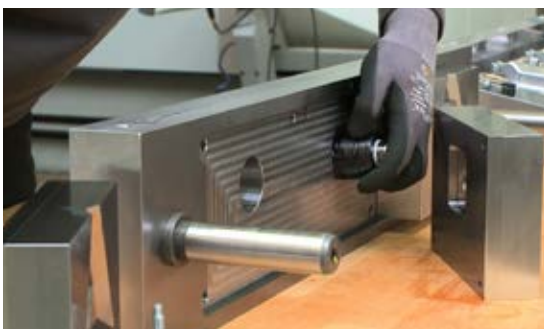
Eindmontage van het bovengereedschap
