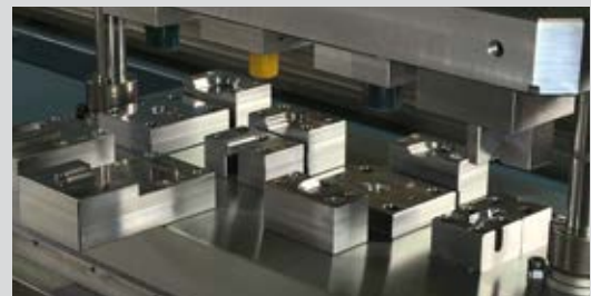
Volledige weergave van het zuilengeleide speciaal gereedschap om de aansluit delen te verbinden met de componenten
