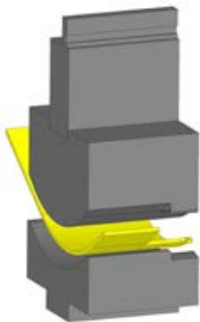
Radius doordrukgereedschap t.b.v. meervoudige buigingen in één bewerking van 2 zijdelingse kanten
