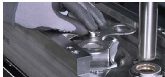
2e en 3e productiestap: Inleggen van de plaat en de bovenste binnenring in alle drie de stations
