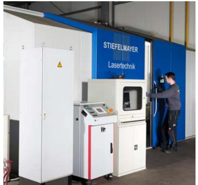
Lasertechniek: Harden tot L = 5.000 mm en markeren van gereedschappen
