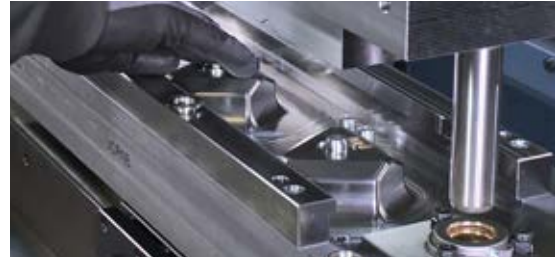
1e productiestap: Inleggen van de bovenste binnenringen in alle drie de stations
