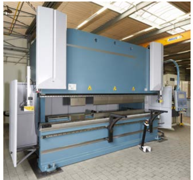
Kantpers voor proefzettingen L = 4.050 mm, perskracht: 3200 kN
