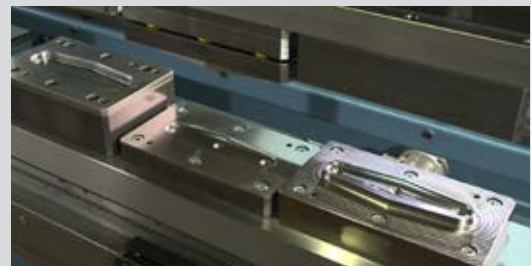
Volledige weergave van het speciaal gereedschap van de kleine spoelarm
