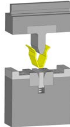
Station 2: U-buiggereedschap met geveerde uitwerper
